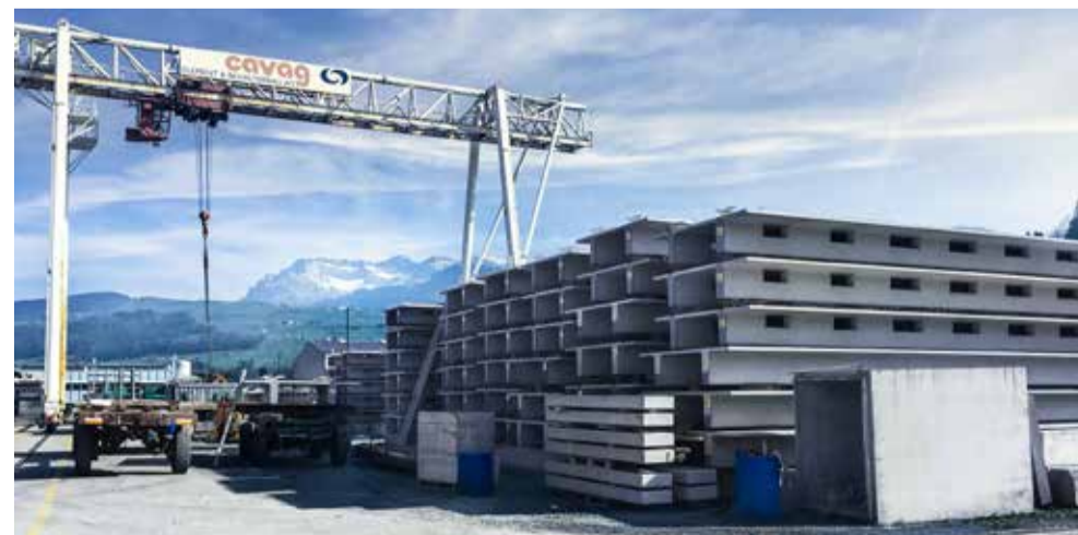
Per il nuovo centro tecnologico della Radiotelevisione Svizzera sono stati prodotti complessivamente 250 solai TT.
