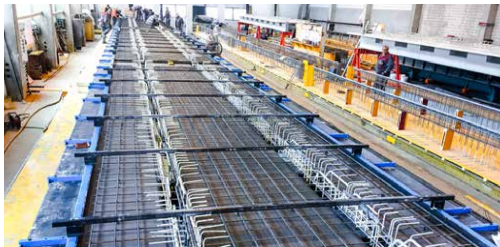
Sul basamento possono essere montate due diverse casseforme.
