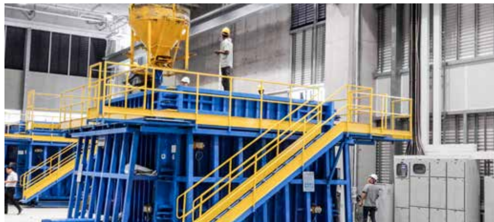
Con i casseri 3D forniti da Bathsystem a Singapore e a Bangkok, i moduli bagno prefabbricati vengono prodotti in due parti e ricomposti sui banchi di produzione.
