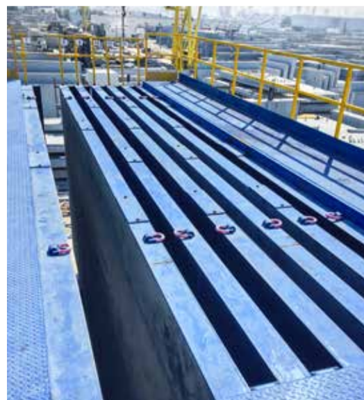
Grazie alla precisione delle superfici delle lamiere di getto, gli elementi prefabbricati in calcestruzzo sono lisci da entrambi i lati.
