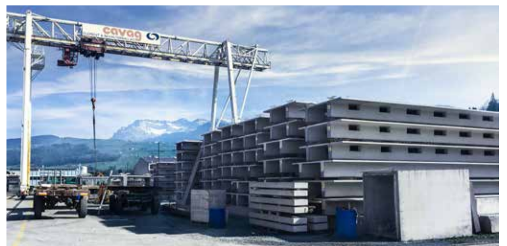
Für das neue Technikcenter des Schweizer Fernsehens wurden insgesamt 250 TT-Decken produziert.
