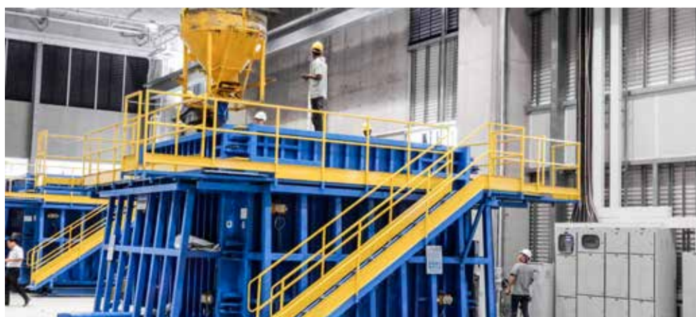
Mit den von Bathsystem nach Singapur und Bangkok gelieferten 3D-Schalungen werden die Fertigbäder in zwei Teilen produziert und anschließend auf Produktionstischen zusammengesetzt.
