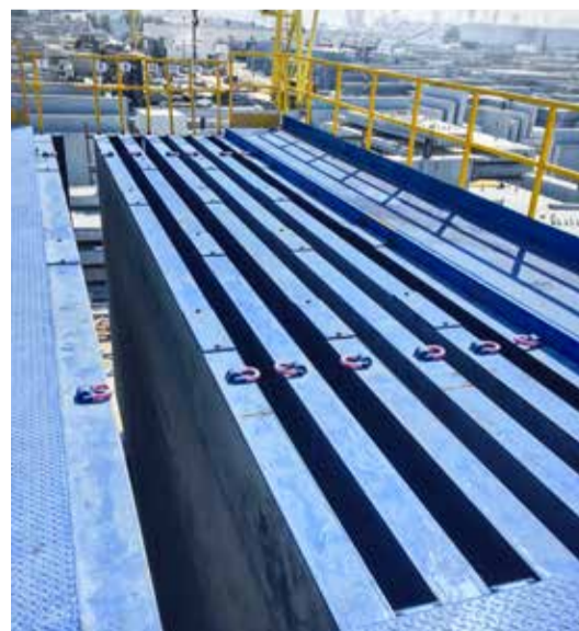
Dank der präzise geschliffenen Schafflächen sind die Betonfertigteile beidseitig metallschalungsglatt.
