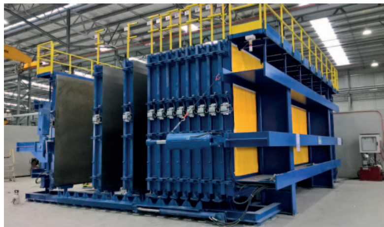
Die Batterieschalung von Tecnom wurde kürzlich bei BGC, der ersten Firma, die diese Technologie in Westaustralien nutzt, installiert.
